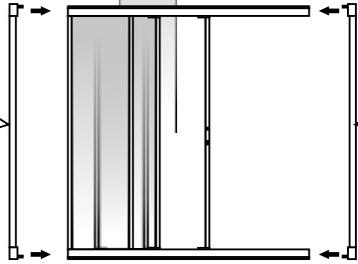
Applicare i montanti laterali alla struttura del sopravasca, rispettando i versi di applicazione illustrati (in funzione del verso di apertura desiderato)
