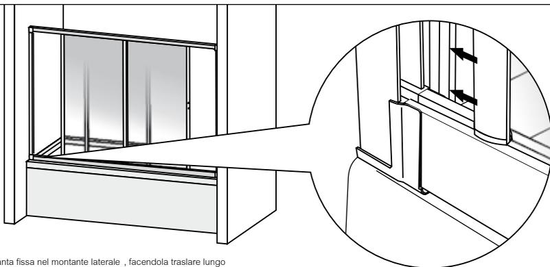
Riposizionare anta fissa nel montante laterale, facendola traslare lungo lo scasso del binario di scorrimento
