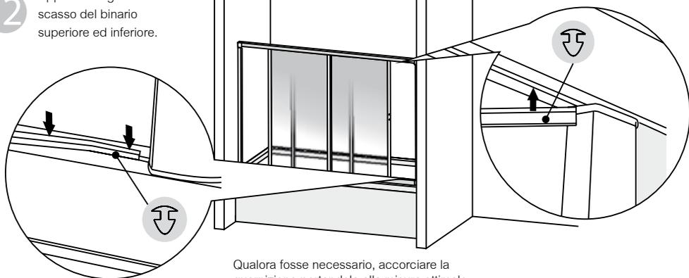
Qualora fosse necessario, accorciare la guarnizione portandola alla misura ottimale.
